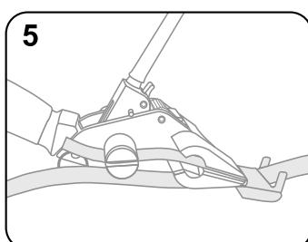
Протягніть сталеву стрічку через направляючий пристрій і вісь натягу стрічки. Вільний кінець стрічки повинен становити щонайменше 10-15 мм.
