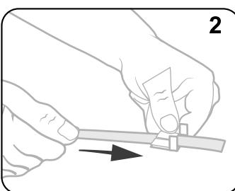
Протягніть один кінець стрічки через бугель або скріпу, розгорнувши провушинами від себе. Загніть кінець стрічки на необхідному для монтажу відстані.
