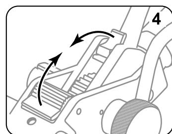
Встановіть стопорну собачку і блокатор вільного ходу згідно з рисунком. Для зручнішої установки стрічки вільно обертайте гвинт натягу.
