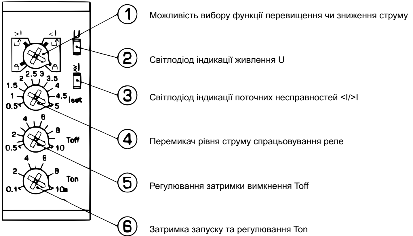
Рисунок 5 - Лицьова панель реле
